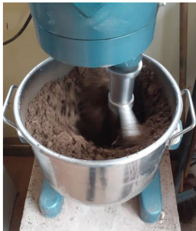
Figura 11 – Mistura do solo-cimento.
