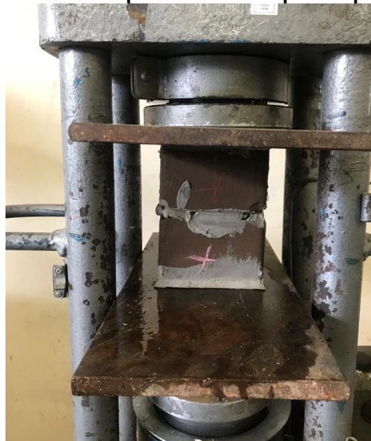
Figura 15 – Rompimento dos corpos de prova.
