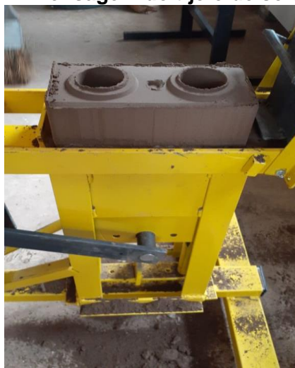
Figura 14 – Prensagem do tijolo de solo-cimento.
