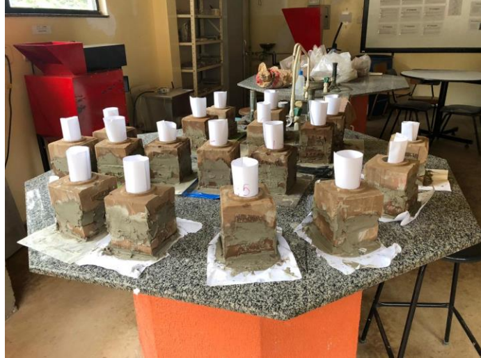
Figura 16 – Capeamento dos tijolos de solo-cimento.
