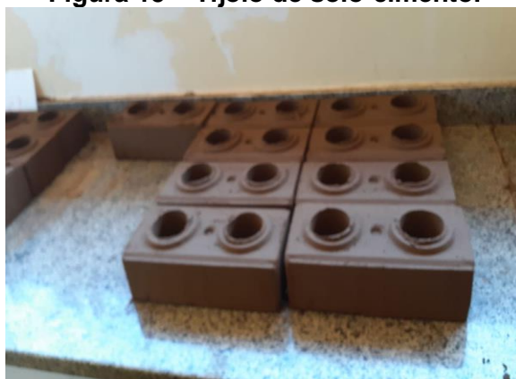
Figura 15 – Tijolo de solo-cimento.
