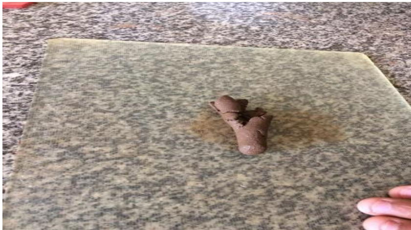
Figura 10: Moldagem do cilindro para ensaio de plasticidade
