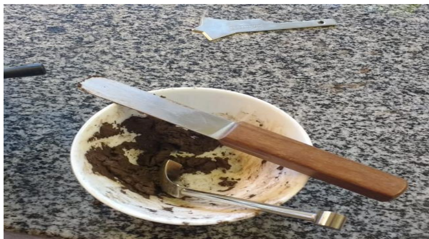
Figura 9: Mistura de solo para o ensaio de limite de liquidez
