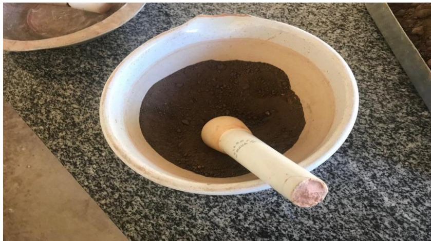
Figura 4 – Destorroamento do solo
