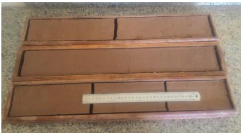
Figura 13: Medição da retração do solo
