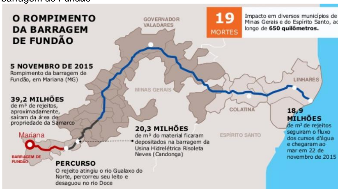
Figura 1 - Imagem do percurso da lama de rejeitos oriunda do rompimento da barragem de Fundão
