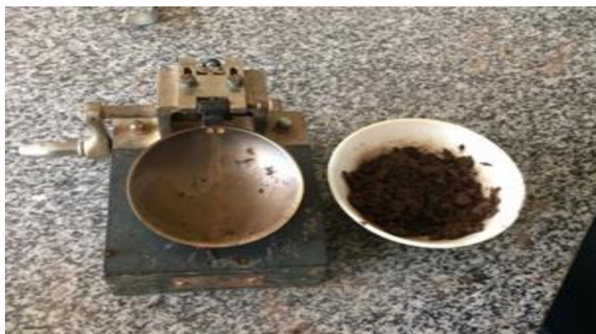
Figura 8: Solo na concha do casagrande com a canelura executada
