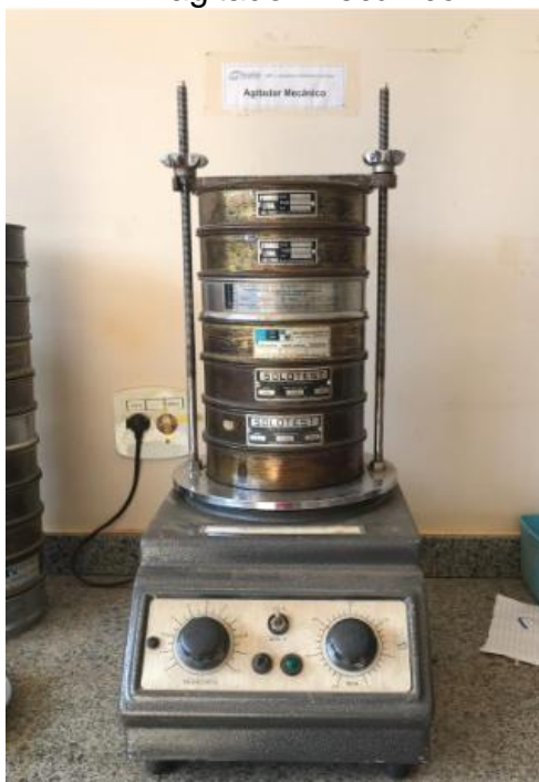
Figura 12: Conjunto de peneiras e agitador mecânico
