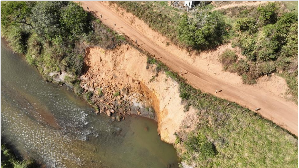
Erosão instalada na margem direita do rio Gualaxo do Norte, na propriedade E031.
