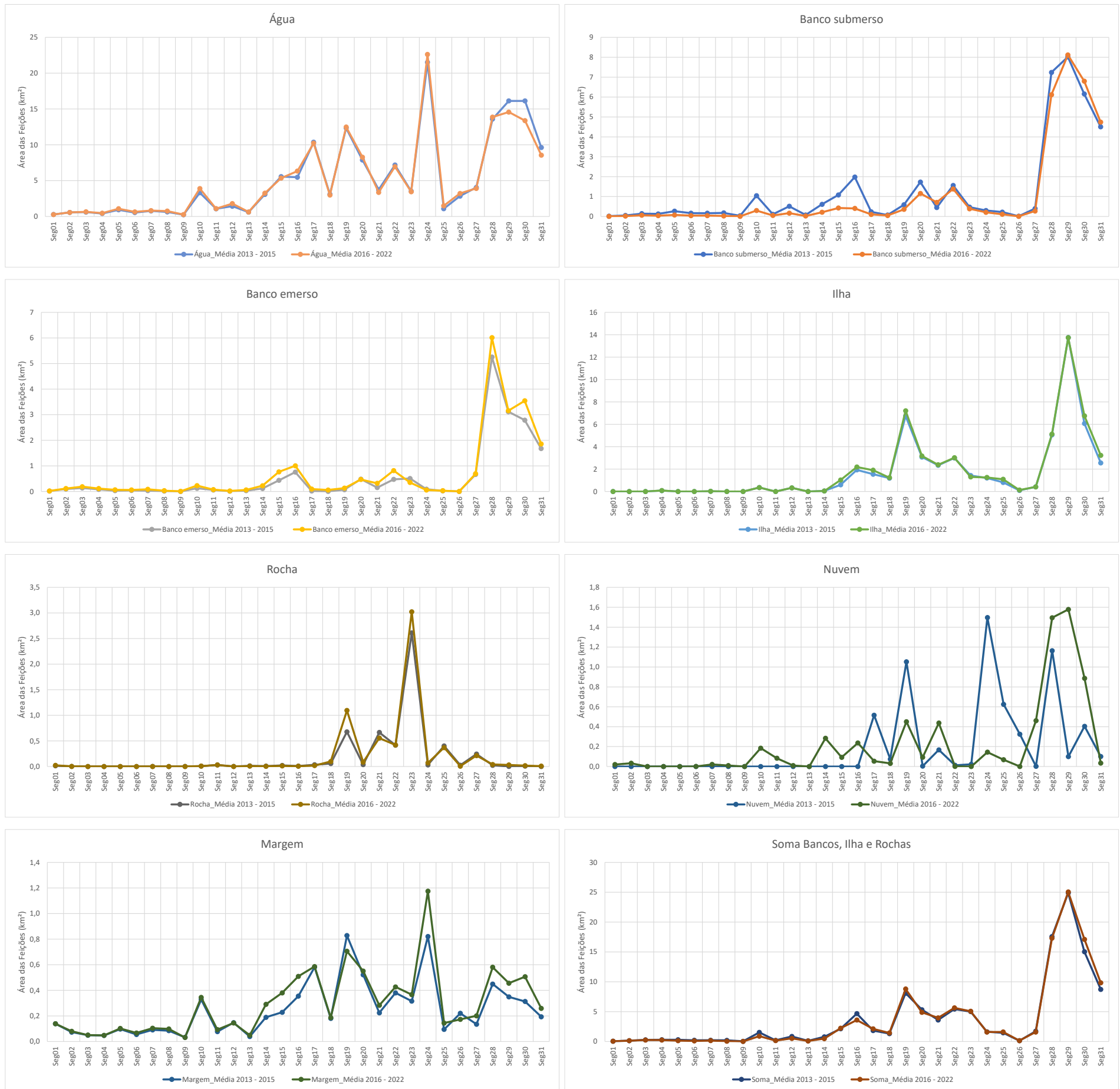
Figura 60 – Comparação da média das áreas das feições geomorfológicas entre 2013-2015 (pré) e 2016 e 2022 (pós-rompimento) em cada segmento do rio Doce a jusante da UHE Risoleta Neves.
