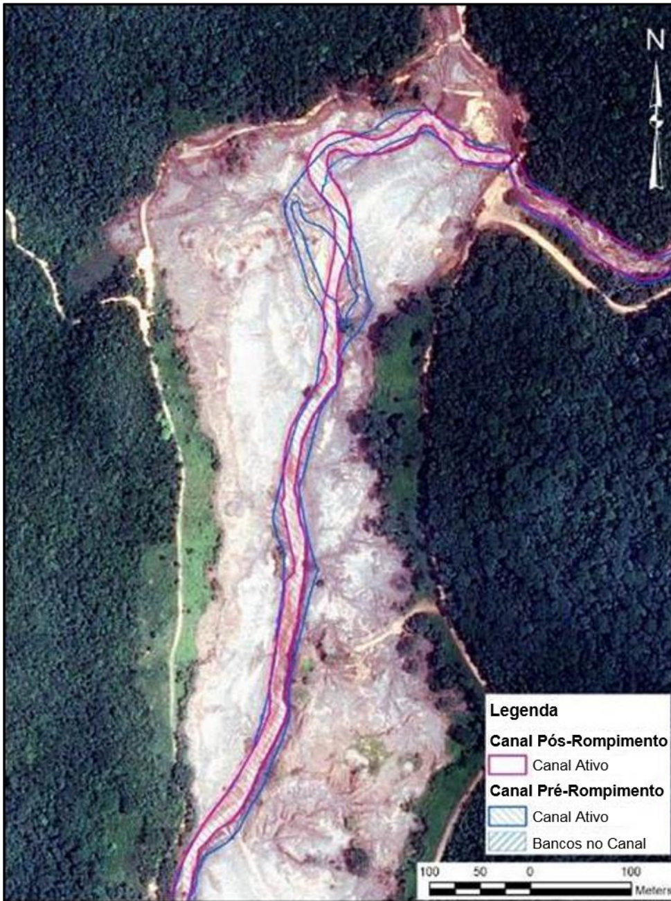
Figura 3.5.32: Delimitação do Canal Ativo Pós- Rompimento para Trechos de Rio com Planícies de inundação Largas.
