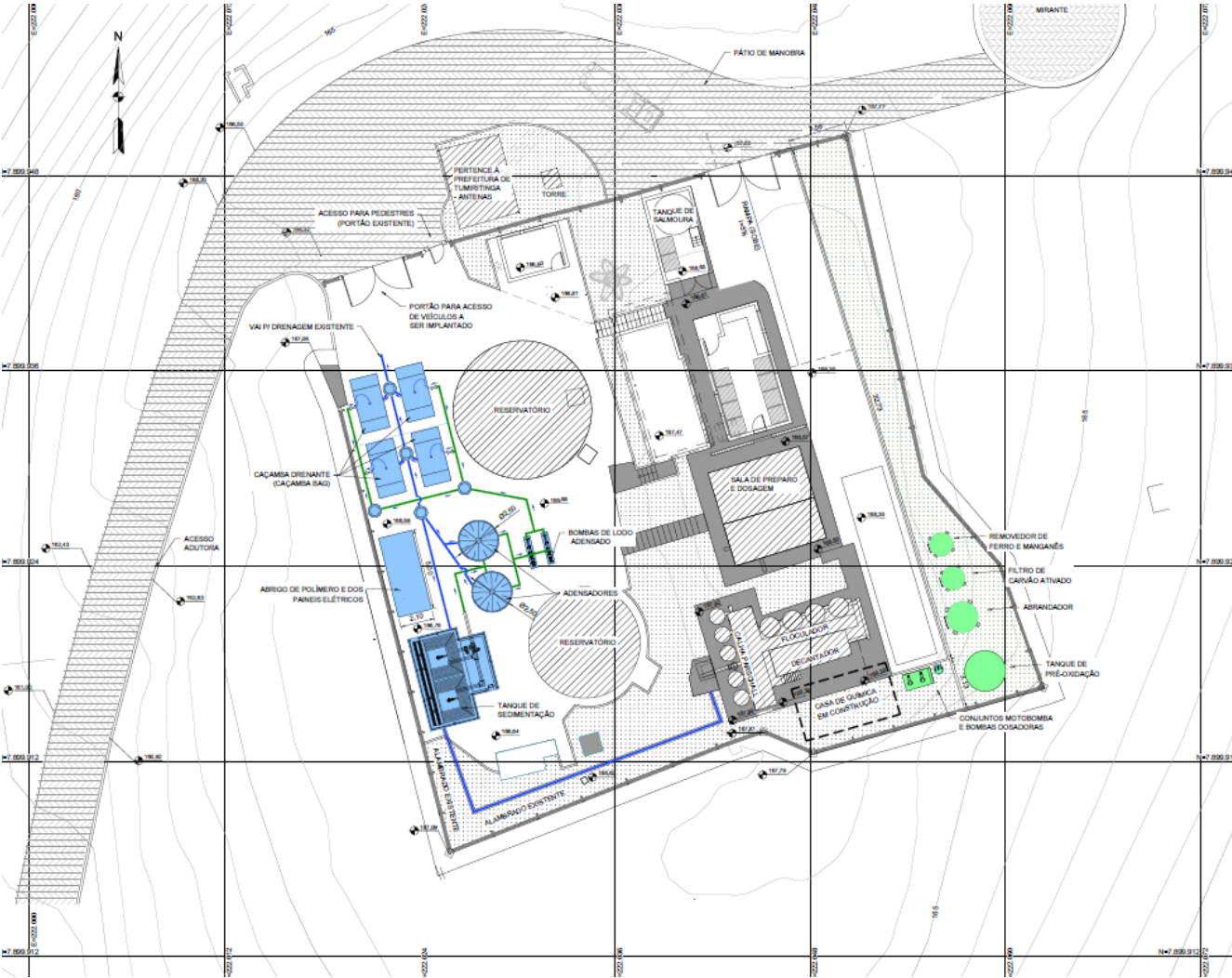
Figura 12 – Layout de implantação da UTR na área da ETA Fonte: HIDROBR (2024)
