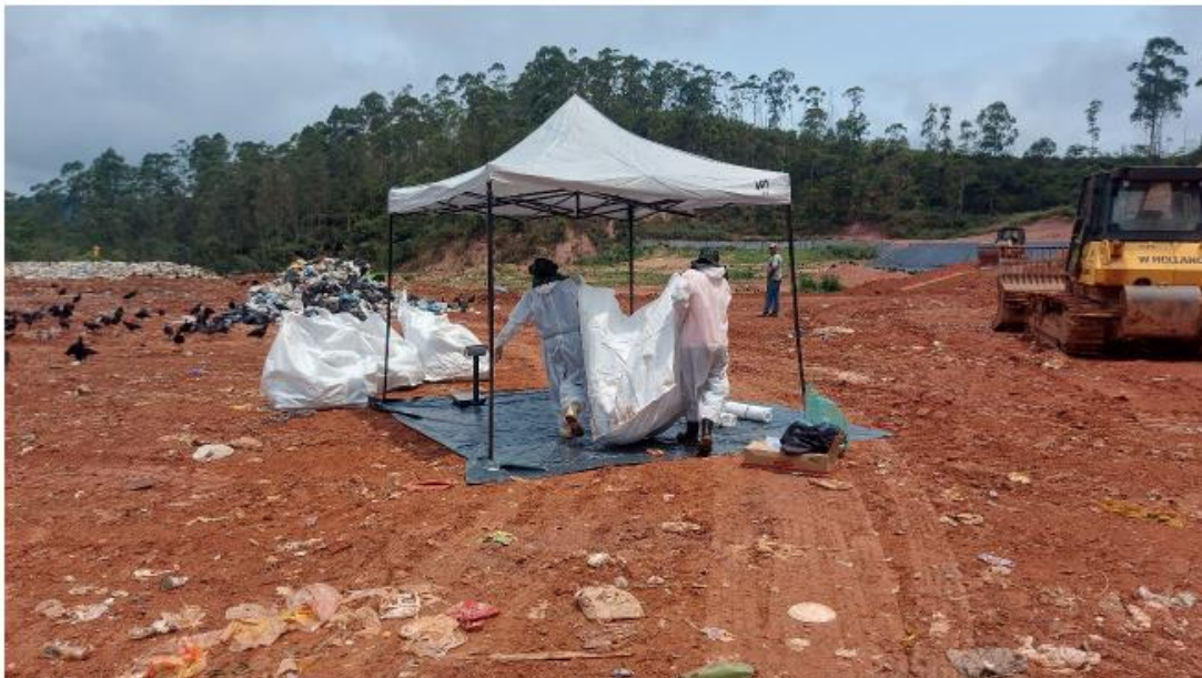
Figura 11 - Local da triagem e pesagem dos resíduos sob lona e a tenda. Fonte: Dos Autores.
