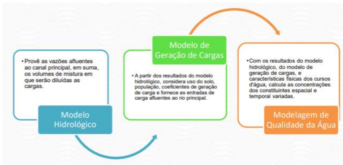
Figura 01 - Modelagem aplicada para a definição da atual classe do rio Doce (ANA, 2023).
