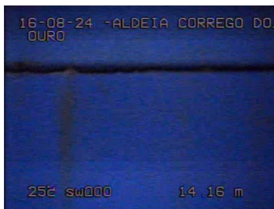
Fotos 14 e 15: Aos 12,74 metros, em visada lateral, identificou-se o nível d'água (N.A.). Posteriormente, aos 14,16 metros, observa-se uma conexão tubo x tubo.
