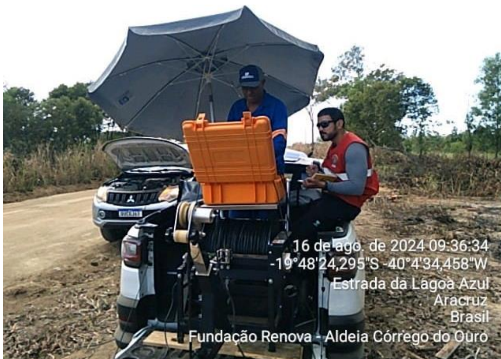
Foto 1: Execução da perfilagem ótica no poço da Aldeia Indígena Córrego do Ouro, em Aracruz, ES.
