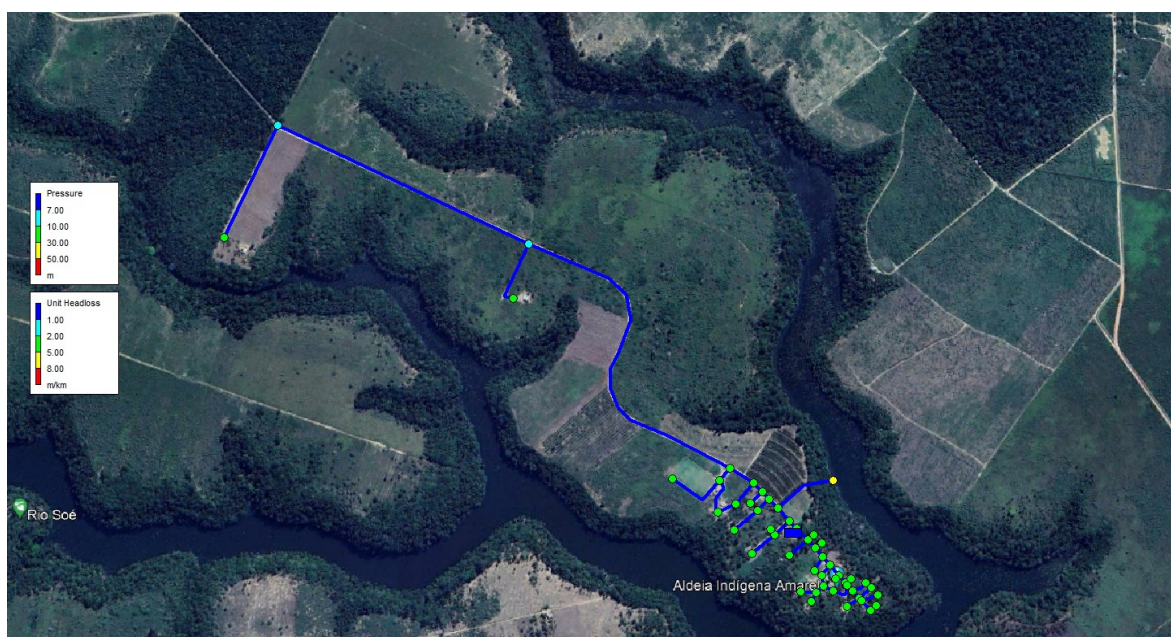
Figura 8: Simulação Hidráulica da Rede de Distribuição – EPANET
