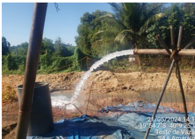
Foto 4 – Teste de Vazão na comunidade de Amarelos, em 21.05.24
