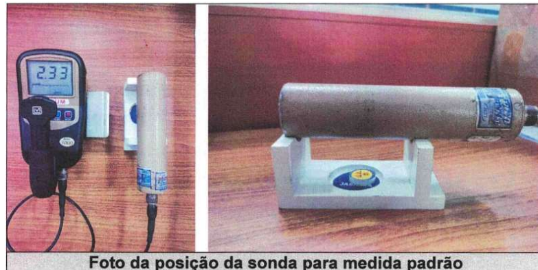
Foto da posição da sonda para medida padrão
