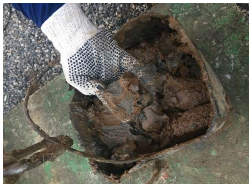
Interior da torre de armazenamento de água antes da reforma (à esquerda) e material lodoso retirado. (Crédito: Divulgação Fundação Renova)
