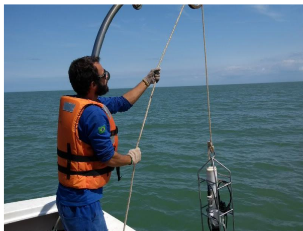
Coleta de dados hidroceanográfico com o CTD no início do perfil - região marinha costeira do Estado do Espírito Santo - junho/2018
