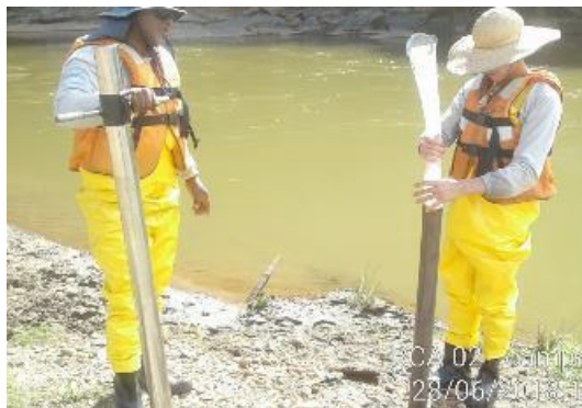
Coletas de testemunho de sedimentos em rios – Junho/2018 (Crédito: Divulgação Fundação Renova)
