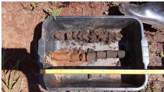
Coleta de sedimento para caracterização ambiental no trecho 9, no rio Gualaxo do Carmo (Crédito: Divulgação Fundação Renova)
